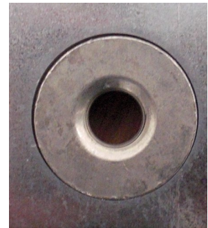
Abb. 6: eingepresste Tube (hier unbeschichtet) mit ungleichmäßigem Verlauf des Fügespalts
