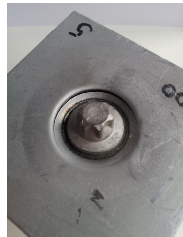
Abb. 9: Versuchsprobe Nr. 5 (ein beschichteter Fügepartner=Tube) nach Abschluss des Prüfvorgangs;
