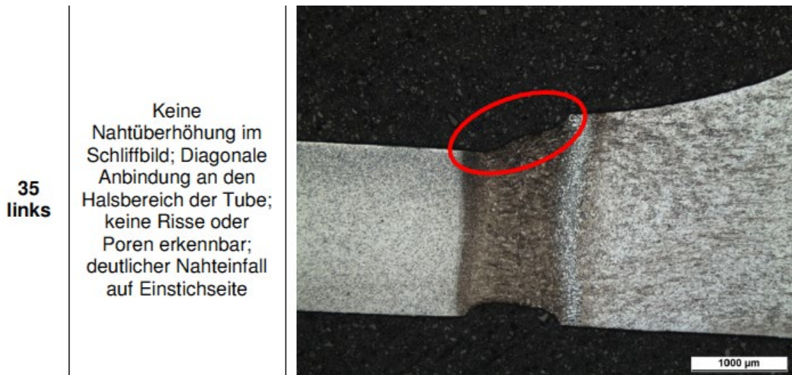
Abb. 14: Querschliff der Probenr. 35 mit unbeschichteter Flanke der Tube
