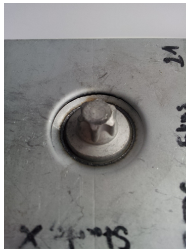
Abb. 8: Versuchsprobe Nr. 21 (unbeschichtete Fügepartner) nach Abschluss des Prüfvorgangs;
