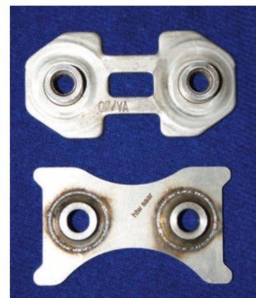
Abb. 9: Napfgezogenes, umgeformtes Bauteil (links) und lasergeschweißtes Funktionsmuster zur Durchführung der Versuchsreihen (rechts).
