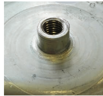
Abb. 7: Vergrößerung eines M8-Gewindedurchzugs, bei dem die konzentrischen Ringe die Anzahl der einzelnen Arbeitsschritte (Stadien) repräsentieren.
