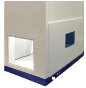
Abb. 10: Bild des Funktionsmusters der einfachen Bearbeitungsstation mit beleuchteter Öffnung für das durchlaufende Transportband (hier ohne Schleusen und Sicht auf die innenliegende Laserstrahlquelle). (Quelle: Jürgen Griebisch)
