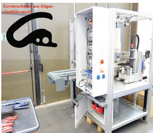
Abb. 6: Vollautomatisierte Mess- und Sortiereinheit für Kurvenscheiben (im Bild oben links dargestellt), wie diese in Abgasrückführventilen von Verbrennungsmotoren in Diesel-PKWs eingesetzt werden 12, 13 .
