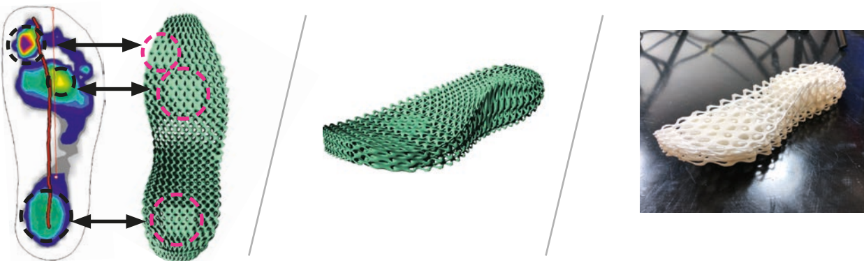
Abb. 3: Schematische Darstellung der CAD-Zeichnung einer orthopädischen, d. h. individualisierten Einlegesohle (Mitte), aufgebaut auf Grundlage einer Pedobarografiemessung (links) und Umsetzung der CAD-Zeichnung als AM-Teil aus Kunststoff Polyamid PA128. (Quelle: Dominique Lehmon, htw saar)
